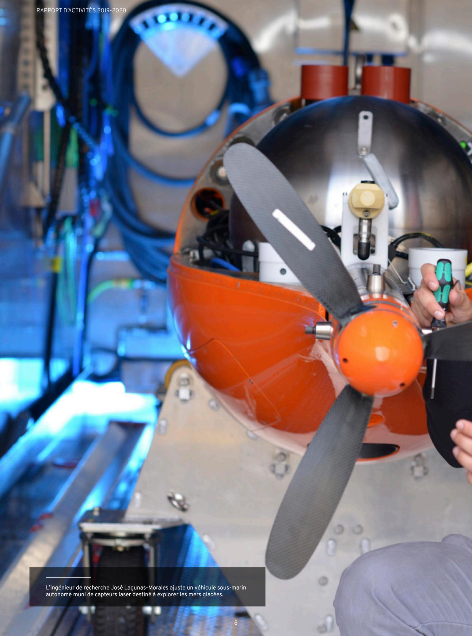
L'ingénieur de recherche José Lagunas-Morales ajuste un véhicule sous-marin autonome muni de capteurs laser destiné à explorer les mers glacées.
